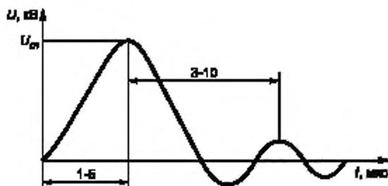
Рисунок Б.3 — Форма импульсов, характерная для точек присоединения *f, g, n* на рисунке Б.1
