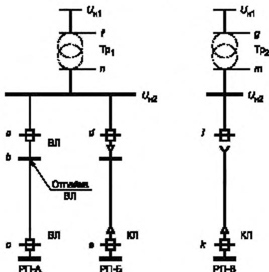
ВЛ — воздушная линия; КЛ — кабельная линия; РП-А, РП-Б, РП-В — распределительные подстанции; Тр<sub>1</sub>, Тр<sub>2</sub> — силовые трансформаторы;  $U_{u1}$ ,  $U_{u2}$  — напряжения на первичной и вторичной обмотках силового трансформатора; а, б, с, d, е, f, g, k, l, m, n — возможные точки присоединения к электрической сети
