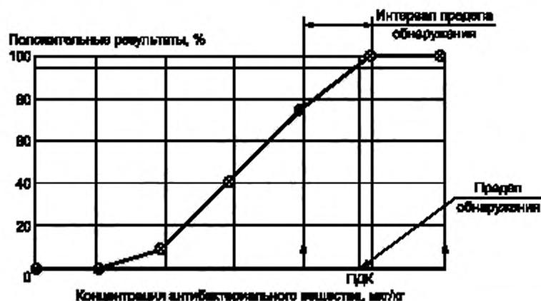
Рисунок 1 — Модель кривой содержание/сигнал для определения предела обнаружения
