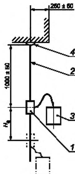
1 — устройство позиционирования на канатах; 2 — анкерный канат;
