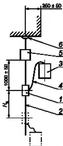
1 — устройство позиционирования на канатах; 2 — анкерный канат; 3 — жесткая стальная масса; 4 — строп; 5 — устройство измерения силы; 6 — анкерная точка а;  $H_a$  — страховочный участок
