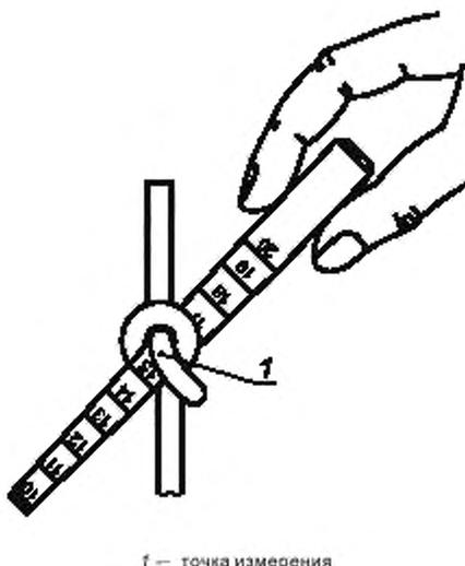
Рисунок 2 — Определение способности к вязке узлов  $K$
