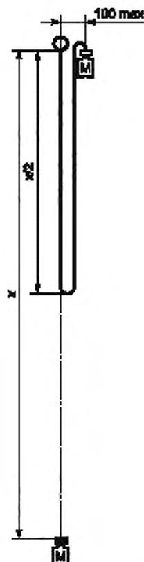
$x$  — расстояние после определения максимальной силы торможения при полной остановке по 5.9.4;
