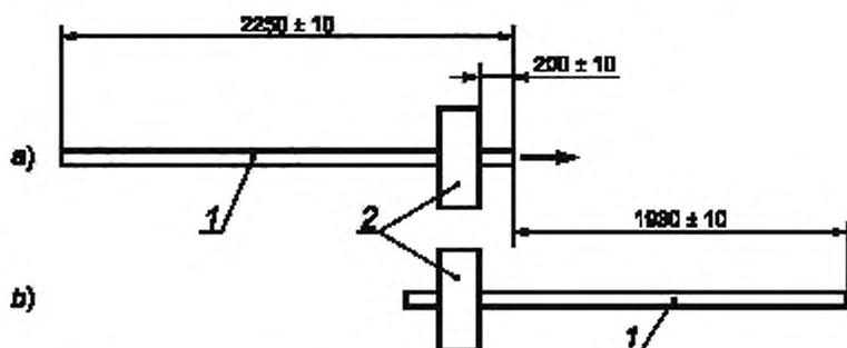
а) — расположение образца до испытания; б) — расположение образца после испытания;
