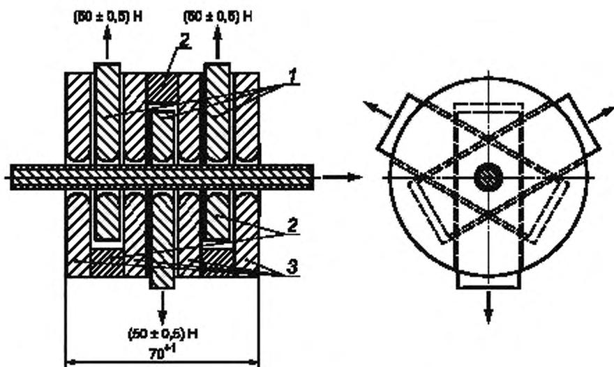
1 — движущие пластины, 2 — пространство; 3 — закрепленные пластины
