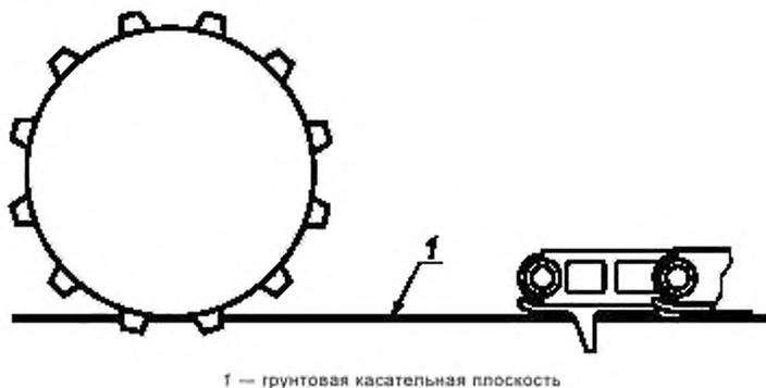
Рисунок 1 — Расположение грунтозацепов на поверхности грунта
