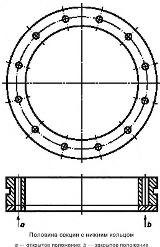
Рисунок А.1 — Схема типового регулируемого воротникового устройства
