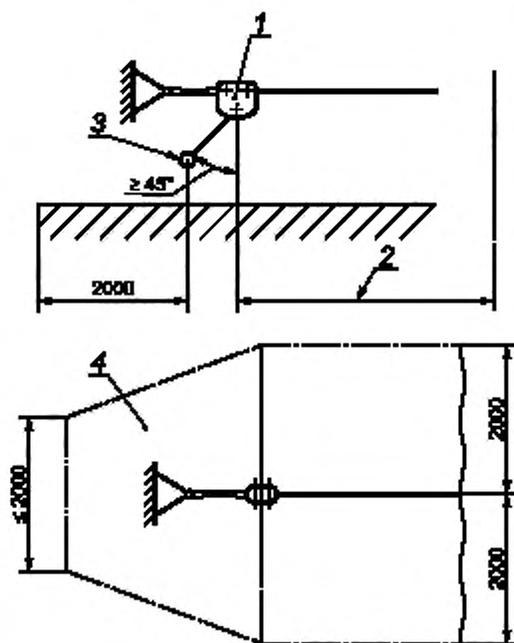
1 — конечная точка движения каретки; 2 — зона катания; 3 — максимальное отклонение при раскидывании сиденья или рукоятки; 4 — зона приземления в зоне остановки каретки
