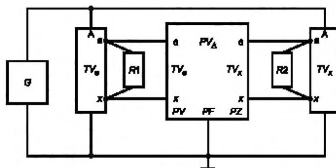
G — источник высокого напряжения;  $TV_0$  — эталонный трансформатор; R1 — нагрузочное устройство эталонного трансформатора;  $TV_x$  — проверяемый трансформатор; R2 — нагрузочное устройство проверяемого трансформатора;  $PV_Δ$  — прибор сравнения; PV — функция измерения входного напряжения; PF — функция измерения частоты входного напряжения; PZ — функция измерения нелинейных искажений
