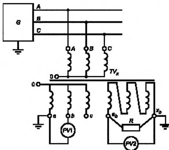
$TV_x$  — поверяемый трансформатор.  $G$  — источник трехфазной системы напряжений.
