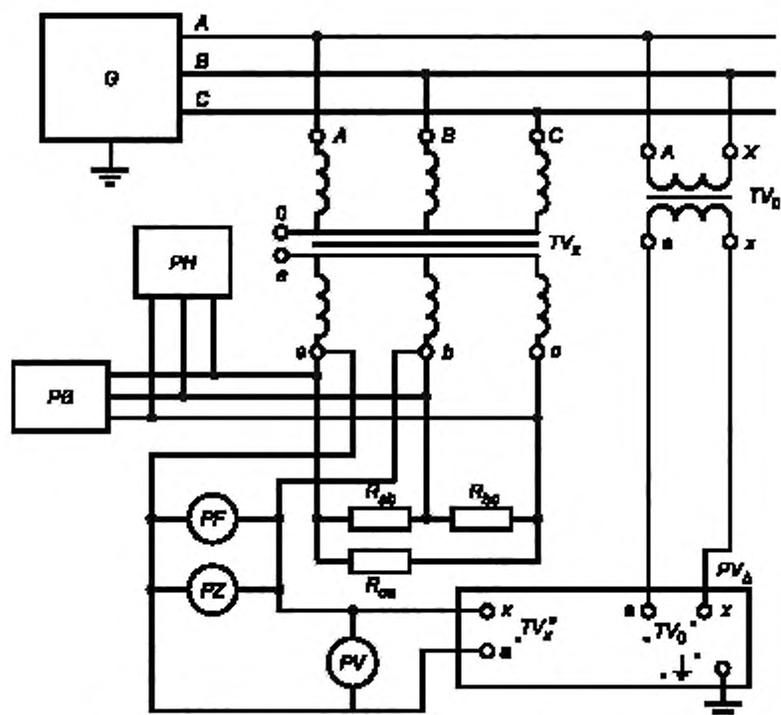
$G$  — источник трехфазной системы напряжений;  $TV_x$  — проверяемый трансформатор,  $TV_0$  — эталонный трансформатор;
