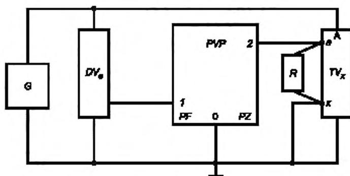
$G$  – источник высокого напряжения;  $DV_0$  – эталонный делитель;  $R$  – нагрузочное устройство проверяемого трансформатора;  $TV_x$  – проверяемый трансформатор.  $PVP$  – вольтфазометр;  $PF$  – функция измерения частоты входного напряжения;  $PZ$  – функция измерения нелинейных искажений
