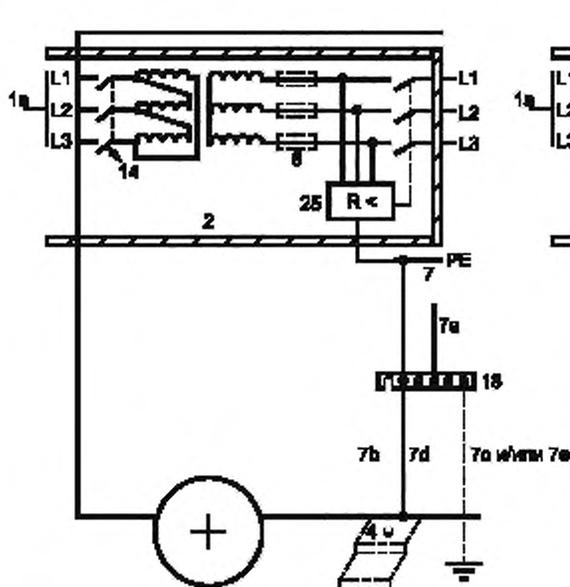
Рисунок 717.5 — Пример соединения с простым разделением и IT-системой с устройством контроля изоляции и отключением после первого замыкания на землю
