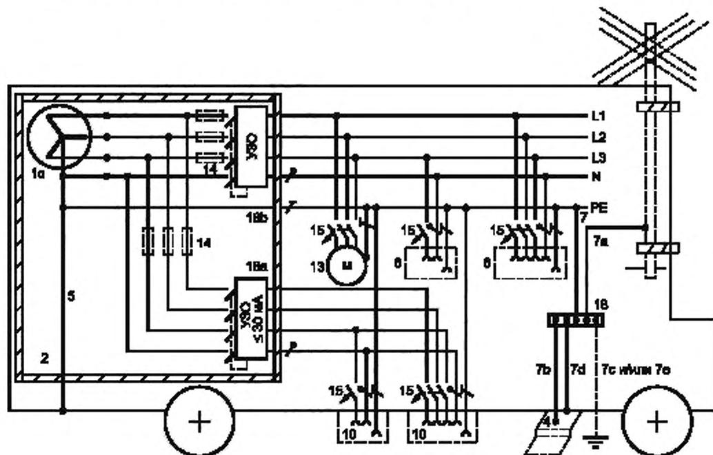
Примечание — Защита автоматическим отключением питания выполняется устройством контроля дифференциального тока (УЗО).
