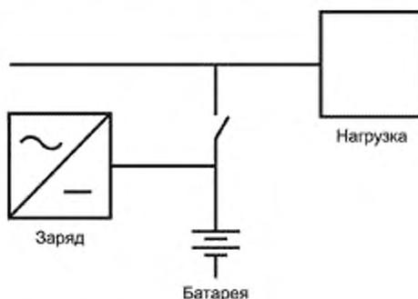
Рисунок А.3 — Принципиальная схема действия цепи
