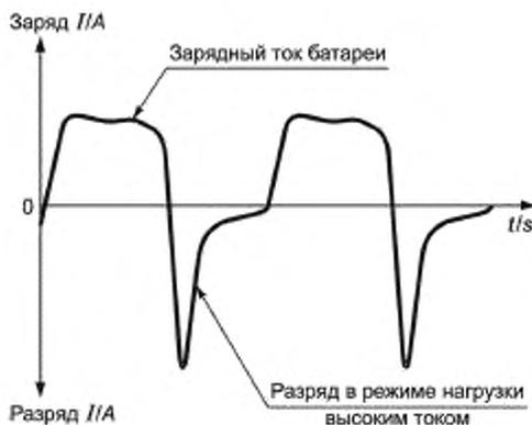
Рисунок А.2 — Зарядный ток батареи при чередовании с временным разрядом, когда ток нагрузки превышает возможности основного источника тока
