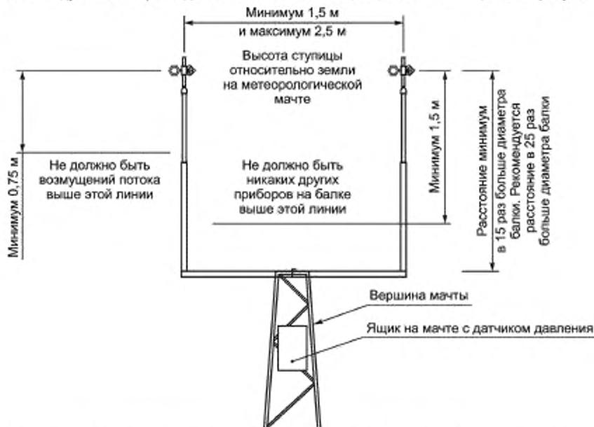
Рисунок G.2 — Пример альтернативного крепления основного и контрольного анемометров в верхней части мачты, а также флюгера и других приборов на балке
