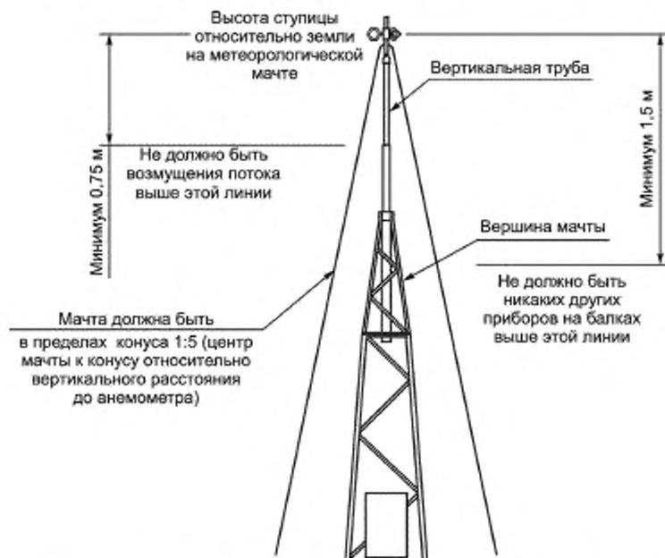
Рисунок G.1 — Пример установки анемометра в верхней части мачты и требования к монтажу
