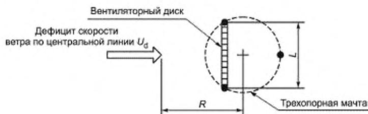
Рисунок G.7 — Представление трехопорной решетчатой мачты с указанием дефицита скорости ветра по центральной линии; представления вентиляторного диска мачты с шириной фронтальной поверхности  $L$  и расстоянием  $R$  от центра мачты до точки наблюдения
