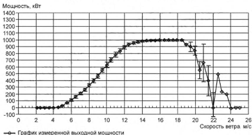
График измеренной выходной мощности с поправкой на плотность воздуха
