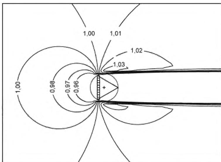
Рисунок G.8 — Поле распределения скоростей воздушного потока вокруг трехлопастной решетчатой мачты с  $C_T = 0,5$ , нормализованное полем скоростей невозмущенного воздушного потока (слева); компьютерный расчет на основе двумерных уравнений Навье — Стокса и по теории вентиляторного диска
