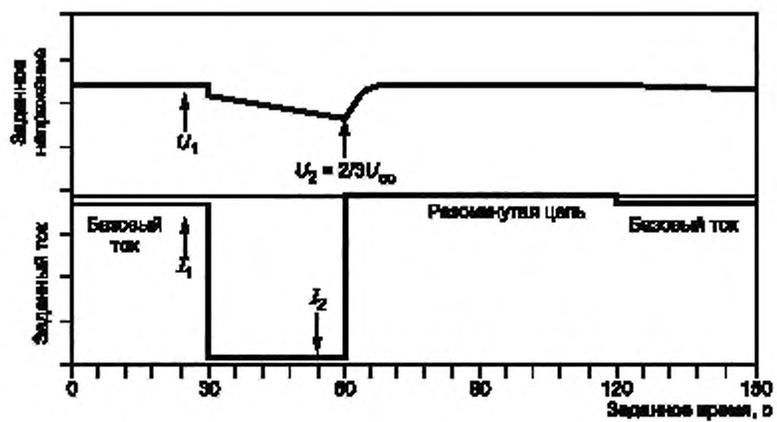
Рисунок 1 — Профиль испытания на пиковую мощность
