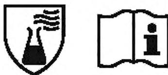
Рисунок 2 — Пиктограммы: защита от химических веществ и руководство по эксплуатации
