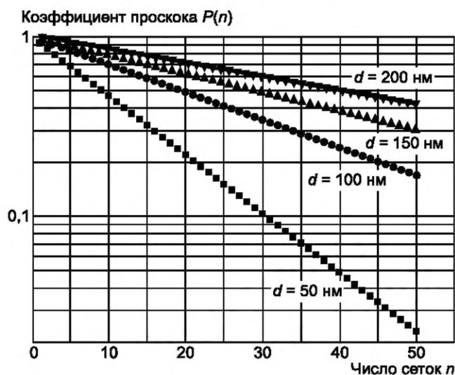
Рисунок А.2 — Теоретическая зависимость коэффициента проскока частиц размерами от 50 до 200 нм от числа сеток при скорости потока аэрозоля 1 дм<sup>3</sup>/мин
