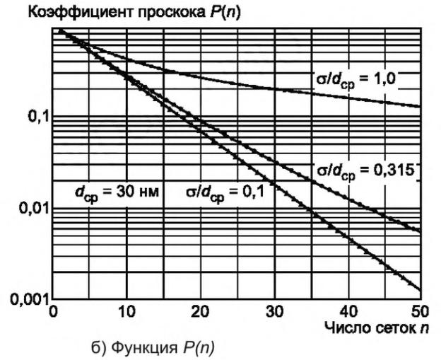
Рисунок А.4 — Теоретическая зависимость коэффициента проскока от числа сеток для частиц размерами 30 нм и относительной шириной распределения от 0,1 до 1,0
