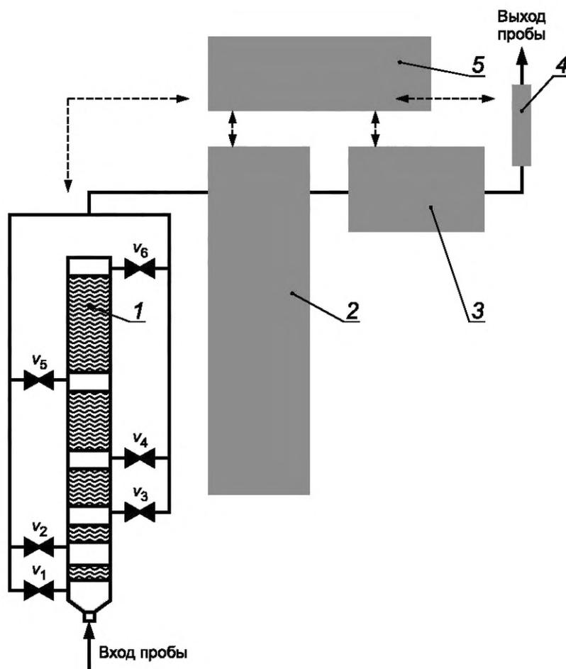
1 — диффузионная батарея; 2 — устройство для укрупнения наночастиц; 3 — средство измерений счетной концентрации; 4 — расходомер; 5 — блок сбора и обработки данных;  $v_1, v_2, v_3, v_4, v_5, v_6$  — клапаны
