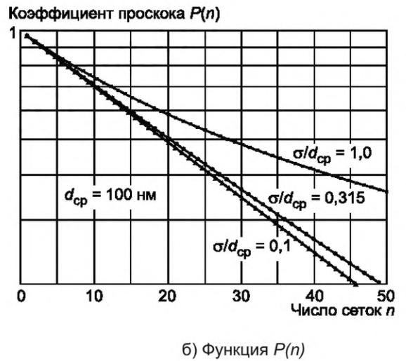
Рисунок А.5 — Теоретическая зависимость коэффициента проскока от числа сеток для частиц размерами 100 нм и относительной шириной распределения от 0,1 до 1,0
