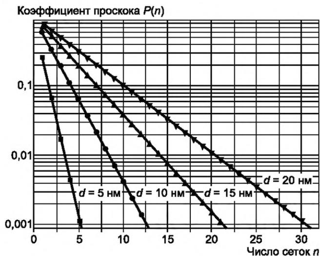
Рисунок А.1 — Теоретическая зависимость коэффициента проскока аэрозольных частиц размерами от 5 до 20 нм от числа сеток при скорости потока аэрозоля 1 дм<sup>3</sup>/мин
