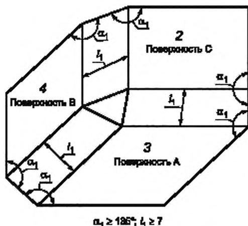
Рисунок А.4 — Пищевая зона. Три соединенные поверхности
