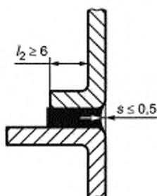
Рисунок А.14 — Зона разбрызгивания. Сварное соединение встык
