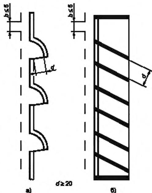
Рисунок А.19 — Вентиляционные отверстия для непищевой зоны
