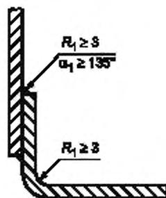
Рисунок А.11 — Пищевая зона. Соединение с соблюдением требований, предъявляемых к закругленным поверхностям пищевой зоны
