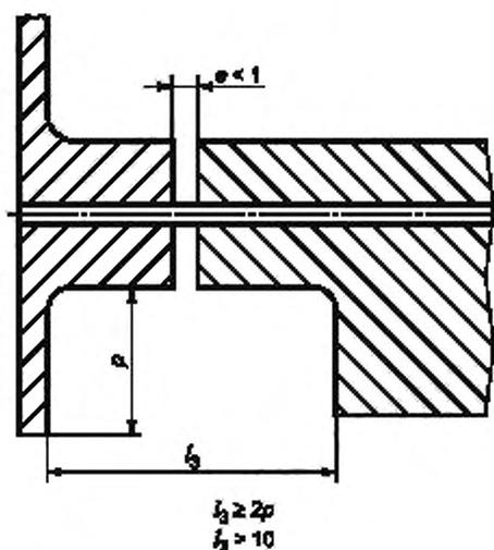
Рисунок А.20 — Шарнирное соединение
