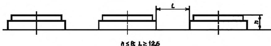
Рисунок А.22 — Расстояние  $L$  между двумя элементами не менее 12,5 мм
