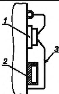
1 — выключено, 2 — включено; 3 — защитный кожух («ВЫКЛ»)
