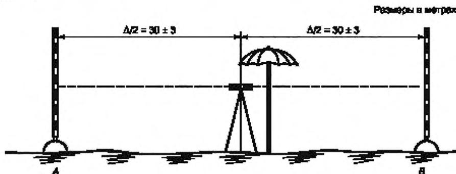
Рисунок 3 — Конфигурация хода для полной методики испытания
