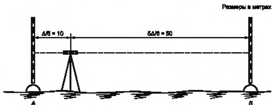
Рисунок 2— Вторая конфигурация хода для упрощенной методики испытания
