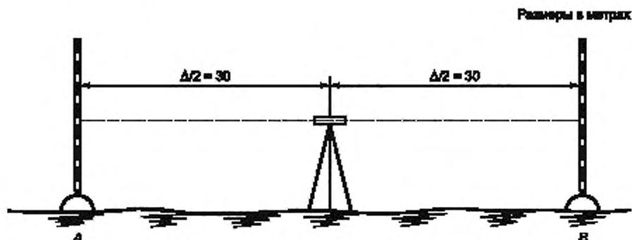
Рисунок 1— Первая конфигурация хода для упрощенной методики испытания
