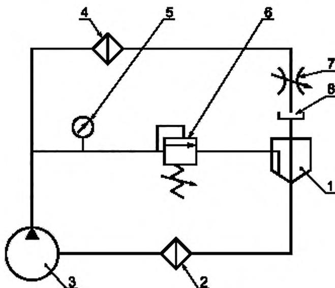
1 — расходный бак; 2 — фильтр I; 3 — насос; 4 — фильтр II; 5 — манометр; 6 — клапан;
