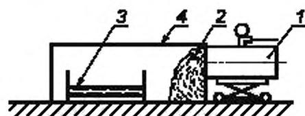
1 — генератор пены высокой кратности на передвижной платформе; 2 — высокократная пена, 3 — противень с горючим; 4 — экран для сбора пены
