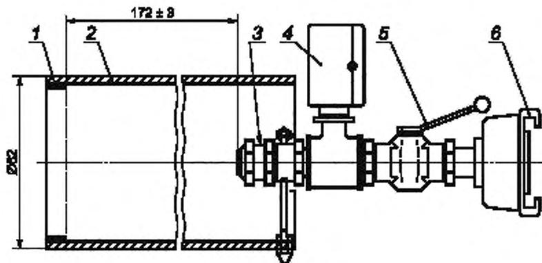
1 — сетка; 2 — корпус; 3 — распылитель; 4 — манометр; 5 — кран; 6 — соединительная головка
