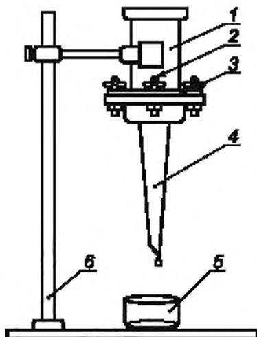
1 — полый цилиндр, 2 — винт, 3 — пластинка из хлопковой ткани;
