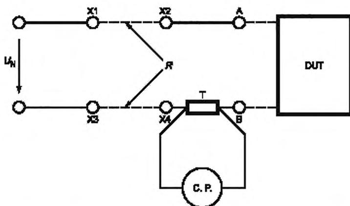
$U_N$  — напряжение питания; DUT — испытуемое устройство управления лампами;  $R$  — дополнительный провод или резистор для текущей настройки;  $T$  — шунт 10 МОм;  $X1, X2, X3, X4$  — зажимы для подключения дополнительного провода или резистора;  $A, B$  — зажимы для короткого замыкания и устройство управления лампами; C.P. — измеритель тока
