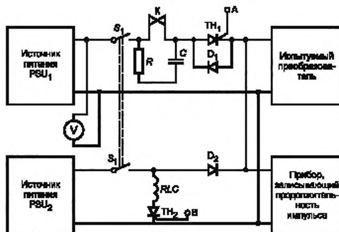
PSU<sub>1</sub> — источник питания, способный обеспечить наибольшее импульсное напряжение (максимальное значение диапазона напряжения + X — номинальное напряжение) с импульсным током, требуемым преобразователем тока при этом напряжении в пределах 2 % (от состояния без нагрузки до полной нагрузки).
