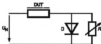
DUT — испытуемое устройство; D — диод, 100 А, 600 В; R — резистор 0 — 200 Ом мощностью не менее половины мощности лампы;  $U_N$  — испытательное напряжение
