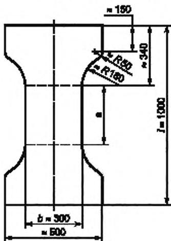
Толщина образцов, предназначенных для испытаний, должна быть равна толщине изделия, из которого они вырезаны, включая толщину обкладки, облицовки и/или покрытия.
