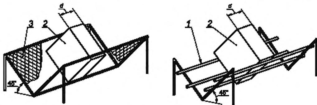
$d$  — толщина образца; 1 — подставка из нержавеющей стали; 2 — образец;
