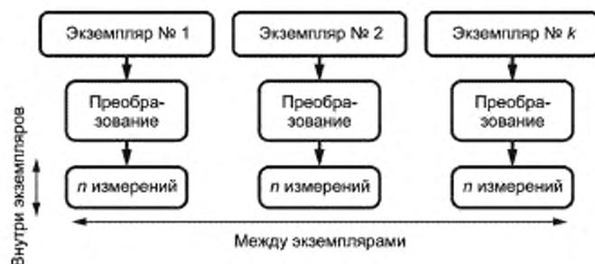
Рисунок 2 — Альтернативная схема определения межэкземплярной неоднородности
