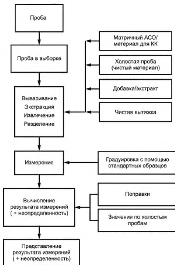
Рисунок 5 — Часть измерительной цепи
