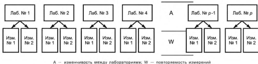
Рисунок А.2 — Однофакторный дисперсионный анализ: план совместного исследования однородности и определения значения аттестуемой характеристики материала СО
