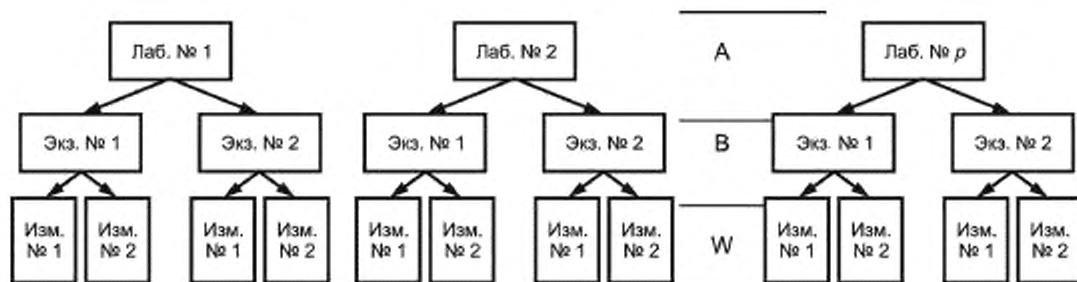
A — изменчивость между лабораториями; B — изменчивость между экземплярами; W — повторяемость измерений
