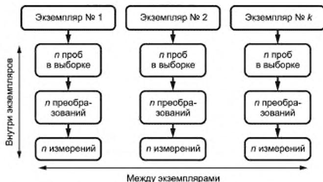
Рисунок 1 — Схема определения межэкземплярной неоднородности
