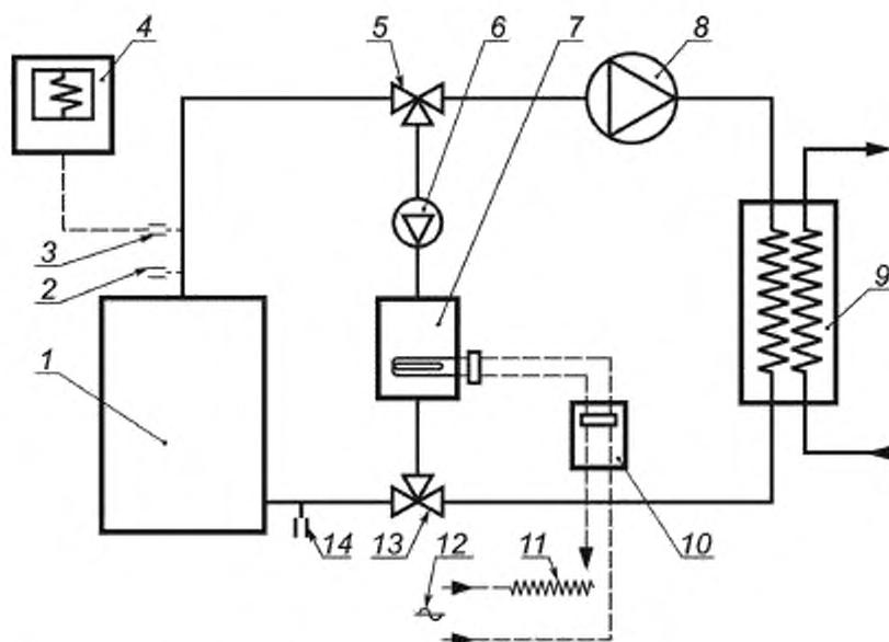
1 — испытуемый котел; 2, 14 — измерители температуры; 3 — термомпара; 4 — записывающее устройство; 5, 13 — трехходовые краны; 6 — циркуляционный насос; 7 — электрический водонагреватель; 8 — дополнительный насос (при необходимости); 9 — теплообменник; 10 — электрический счетчик; 11 — регулятор напряжения; 12 — подвод электропитания
