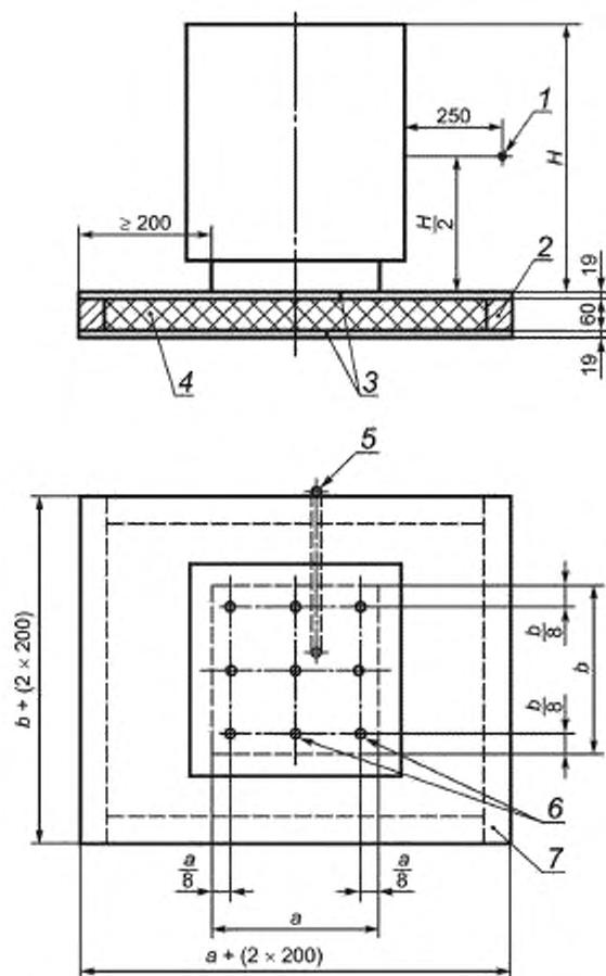
1 — точка измерения температуры воздуха, 2 — рама из четырехгранного бруса; 3 — основная доска с пазом; 4 — стеклопакет; 5 — тонкостенная труба для измерительного кабеля; 6 — точки измерения температуры, 7 — испытательная панель для измерения температуры пола под котлом
