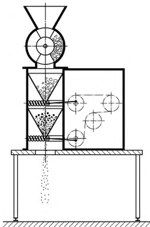
Рисунок А.1 — Пример механической дробилки для почвы
