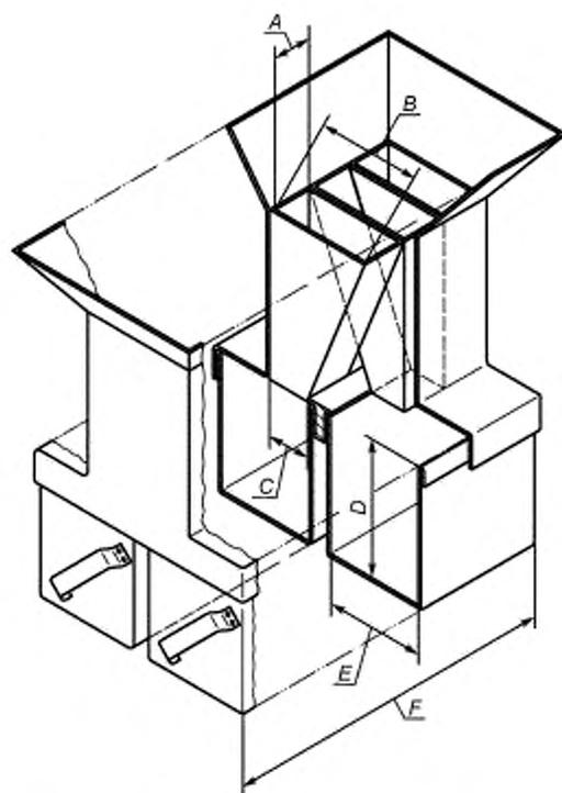
Рисунок А.2 — Пример механического делителя пробы
