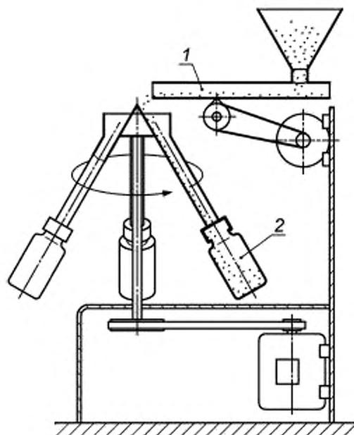
1 — вибрирующая трубка; 2 — бутылка для пробы
