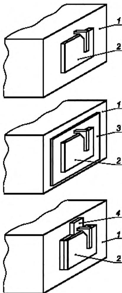
1 — монтажная поверхность; 2 — розетка; 3 — опорная поверхность; 4 — расположение детали, имеющей ту же толщину, что и опорная часть
