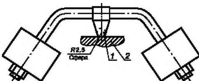
1 — стальной шарик диаметром 5 мм; 2 — образец
