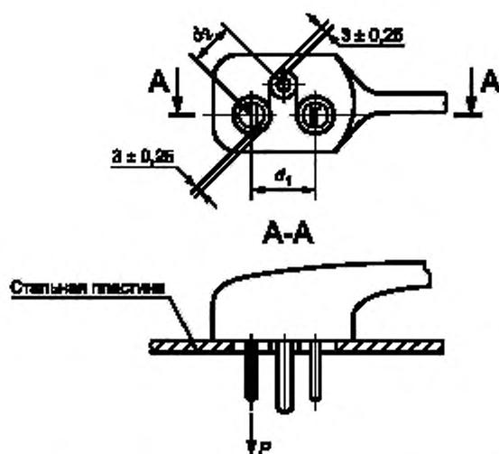
Рисунок 30 — Устройство для проверки механической прочности вилок
