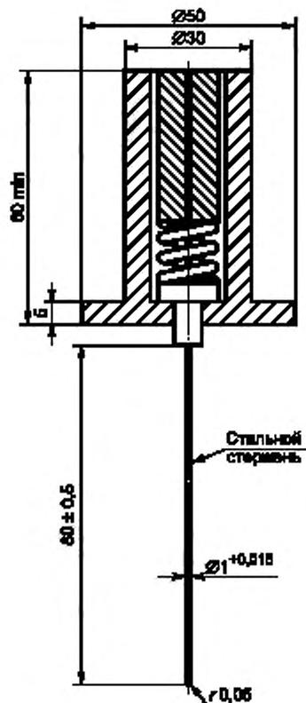
При калибровке прибора силу 20 Н прикладывают к наконечнику жесткого стального стержня вдоль его оси до смещения плоскостей А и Б за счет сжатия внутренней пружины.
