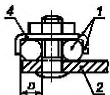
1 — возможный вариант; 2 — неподвижная деталь; 3 — прокладка или прижимная пластина; 4 — специальная прижимная деталь; D — место расположения проводника
