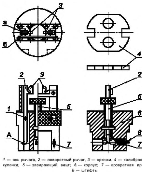
1 — ось рычага, 2 — поворотный рычаг, 3 — крючки, 4 — калиброванные кулачки; 5 — запирающий винт; 6 — корпус; 7 — возвратная пружина; 8 — штифты
