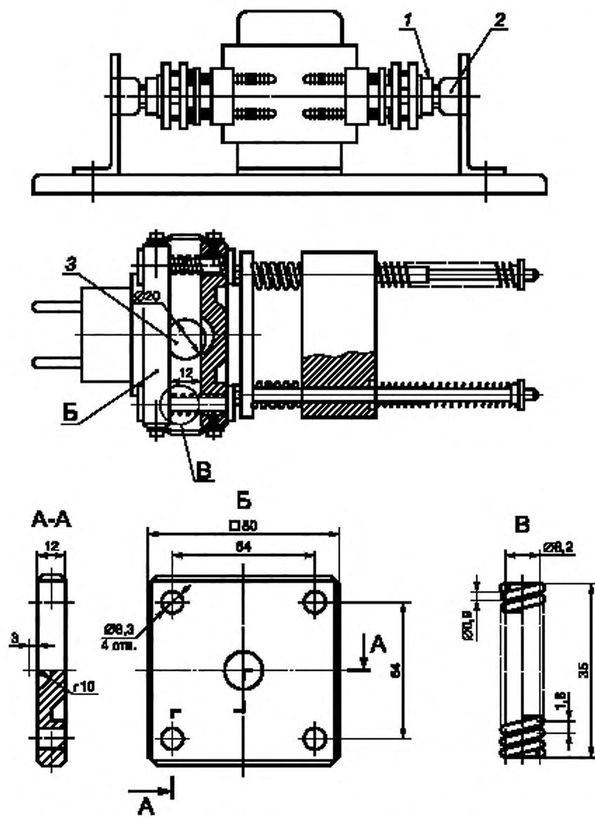
Пружины, отличные от пружины В, выбирают и регулируют таким образом, чтобы в разъединенном положении сила разъема вилки с розеткой обеспечивалась требованиями следующей таблицы:
