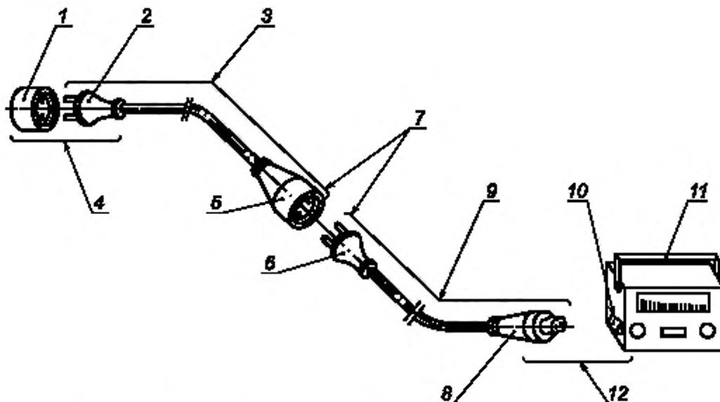
1 — розетка стационарная; 2 — вилка опрессованная; 3 — удлинитель одноместный; 4 — соединитель штепсельный; 5 — розетка переносная опрессованная; 6 — вилка опрессованная; 7 — соединитель штепсельный; 8 — розетка приборная опрессованная; 9 — удлинитель с приборной розеткой; 10 — вилка приборная; 11 — прибор; 12 — соединитель приборный
