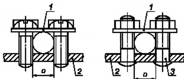
1 — прижимная пластина; 2 — неподвижная деталь; 3 — шпилька;
