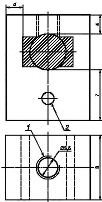
1 — пространство (отверстие) для питающего кабеля; 2 — резьбовое отверстие для зажимного винта
