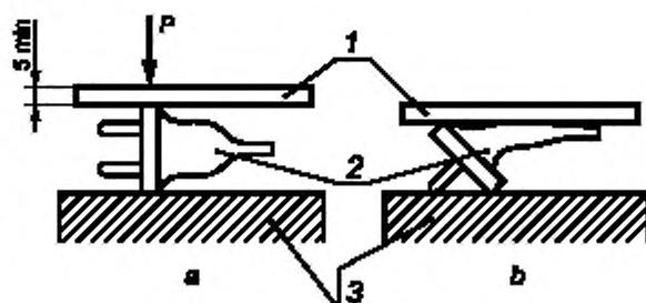
$P$  — сила 150 Н; 1 — стальная нажимная пластина; 2 — образец;
