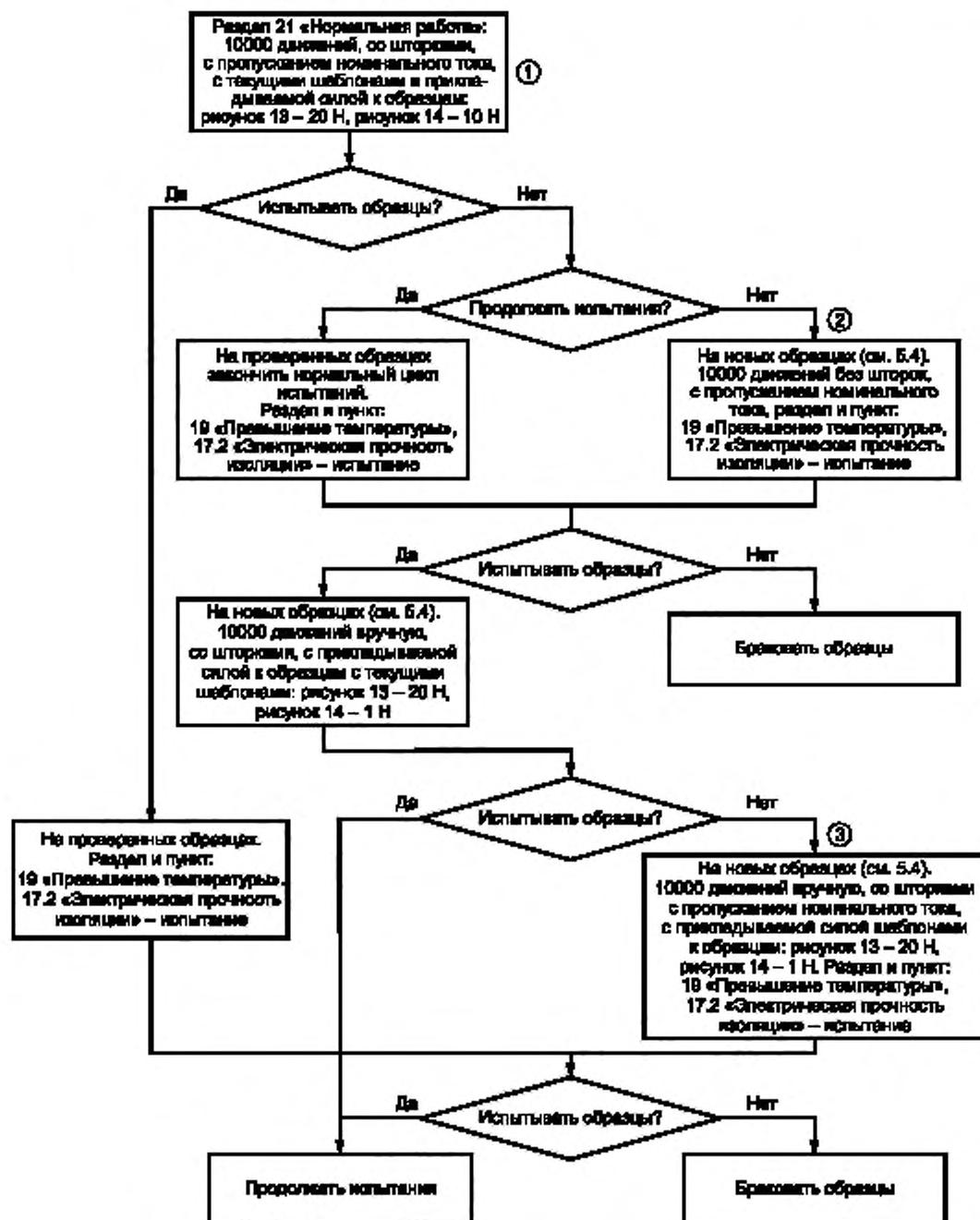
Рисунок 43 — Методика испытаний по разделу 21 «Нормальная работа»
