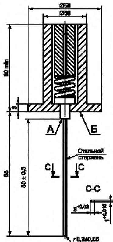
При калибровке прибора силу 1 Н прикладывают к наконечнику жесткого стального стержня вдоль его оси до смещения плоскостей А и Б за счет сжатия внутренней пружины.
