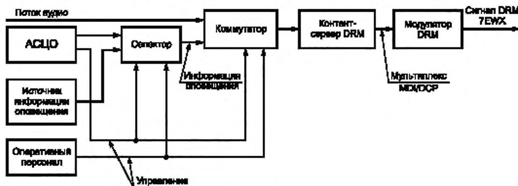
Рисунок 3 — Организация подачи сигналов оповещения на вход контент-сервера передающего тракта DRM вещания
