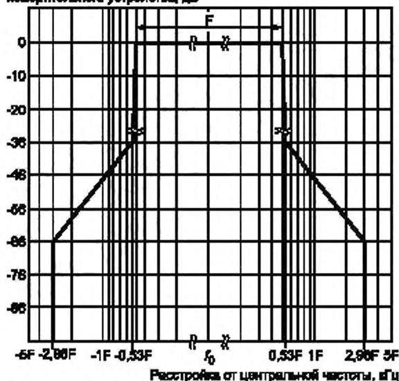
Рисунок 2 — Маска огибающей внеполосных радиопомех в логарифмических координатах
