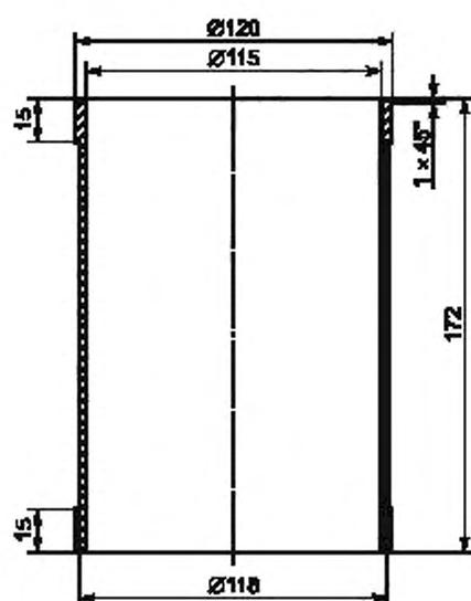
Рисунок 4 — Корпус цилиндра
