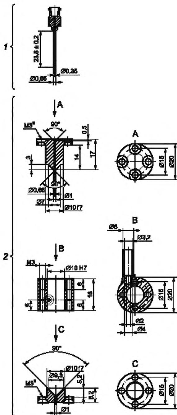
1 — полая игла впрыскивания; 2 — детали двухфазного сопла
