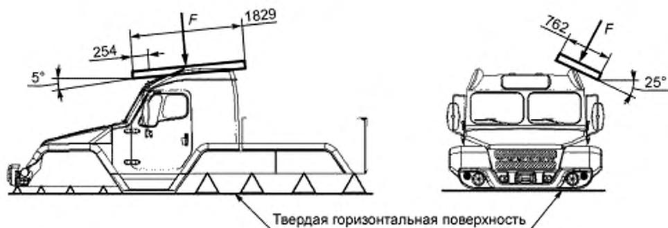
Рисунок 1 — Схема испытания защитных свойств кузова/кабины
