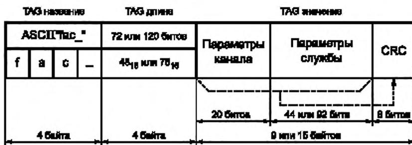
Рисунок 5 — Канал быстрого доступа
