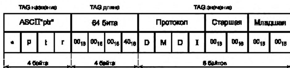
Рисунок 3 — Тип протокола и версия
