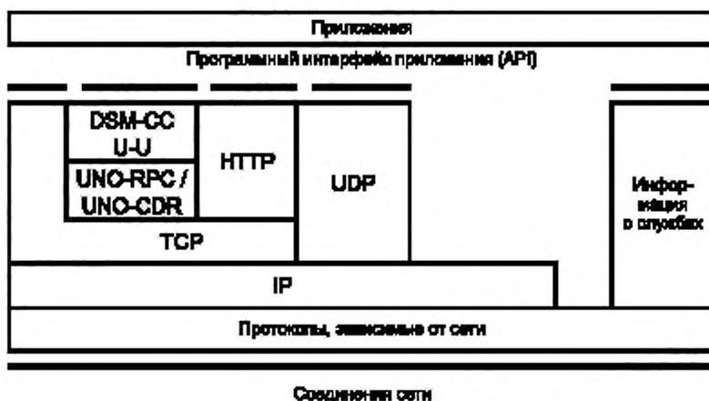
Рисунок 4 — Структура стека протоколов интерактивного канала
