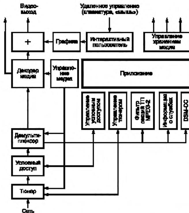
Рисунок 2 — Интерфейсы между приложениями MHP и системой MHP
