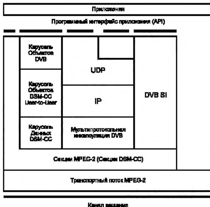
Рисунок 3 — Структура стека протоколов канала вещания DVB
