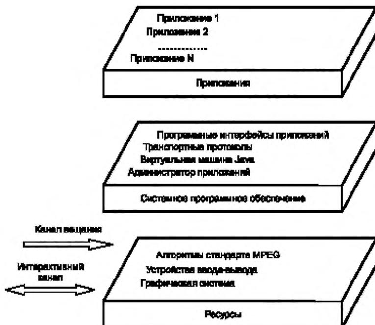
Рисунок 1 — Структура базовой архитектуры платформы MHP
