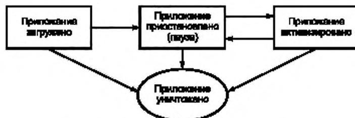
Рисунок 5 — Модель состояний виртуальной машины Xlet
