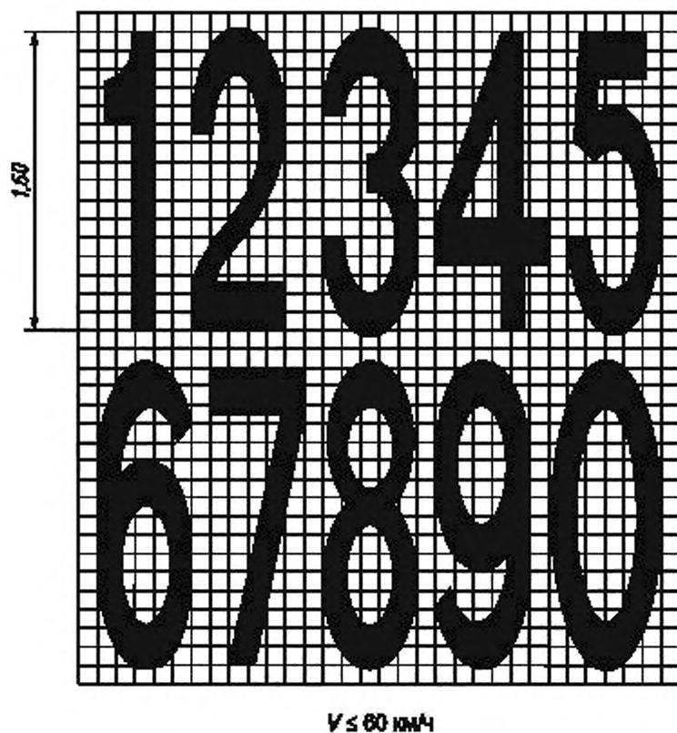
Рисунок Б.6 — Форма, расположение и размеры цифр разметки типа 1.22
