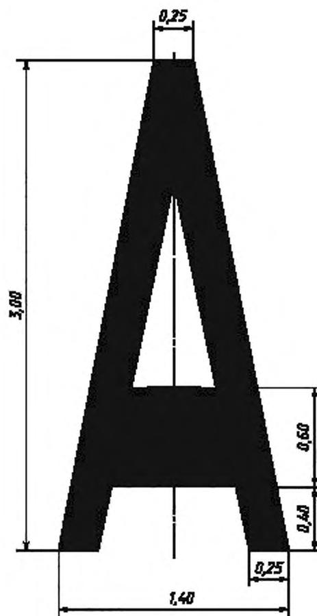
Рисунок Б.9 — Форма и размеры разметки типа 1.23
