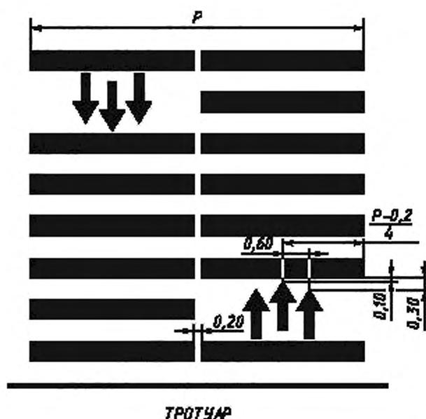
Рисунок Б.1.1 — Расположение стрел на разметке типа 1.14.2.
