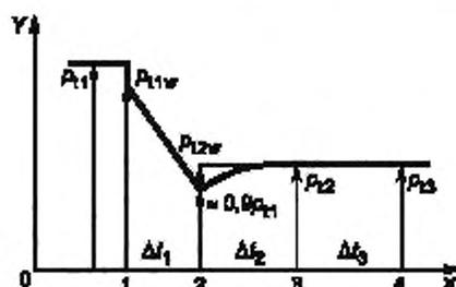
X — время; Y — всасное давление;  $p_{11}$ ,  $p_{12}$ ,  $p_{13}$  — давления в измерительной камере для метода постоянного объема, измеряемые до и после интервалов  $\Delta t_1$ ,  $\Delta t_2$ ,  $\Delta t_3$
