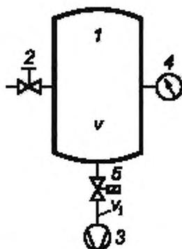
1 — измерительная камера; 2 — клапан напуска газа; 3 — испытуемый насос; 4 — вакуумметр для измерения  $p_{11}$ ,  $p_{12}$ ,  $p_{13}$ ; 5 — быстродействующий клапан;  $V$  — объем измерительной камеры;  $V_1$  — объем соединительного трубопровода между испытуемым насосом и быстродействующим клапаном
