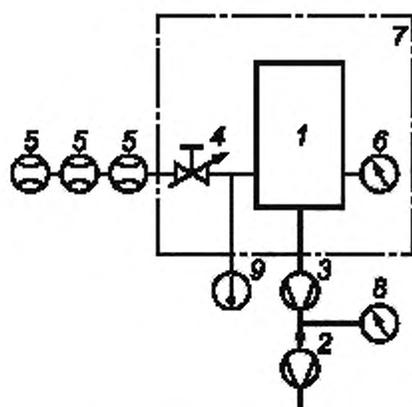
1 — измерительная камера; 2 — форвакуумный насос; 3 — испытуемый насос; 4 — клапан напуска газа; 5 — расходомер для измерения  $Q$ ; 6 — вакуумметр для измерения  $p_1$ ; 7 — нагревательная рубашка (дополнительно); 8 — вакуумметр для измерения  $p_3$ ; 9 — прибор измерения температуры  $T_D$
