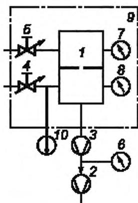
1 — измерительная камера; 2 — форвакуумный насос; 3 — испытуемый насос; 4 — клапан напуска газа; 5 — клапан напуска; 6 — вакуумметр для измерения  $p_3$ ; 7 — вакуумметр для измерения  $p_d$ ; 8 — вакуумметр для измерения  $p_e$ ; 9 — нагревательная рубашка; 10 — прибор измерения температуры  $T_D$
