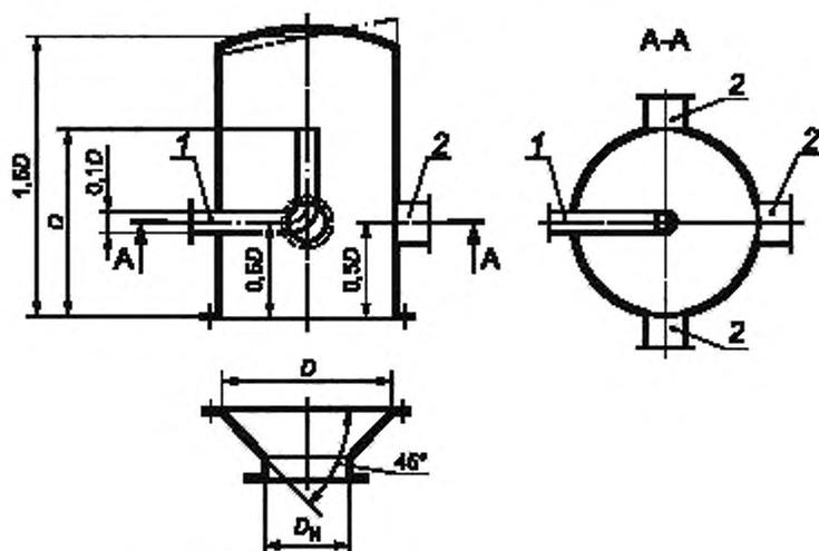
1 — патрубок напуска газа и место измерения температуры  $T_D$ ; 2 — патрубок для подсоединения вакуумметра и масс-спектрометра;  $D$  — внутренний диаметр измерительной камеры, м;  $D_N$  — номинальный диаметр входа переходника, равный впускному отверстию фланца насоса
