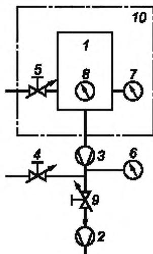
1 — измерительная камера; 2 — форвакуумный насос; 3 — испытуемый насос; 4 — клапан напуска газа; 5 — клапан напуска газа; 6 — вакуумметр для измерения  $p_3$ ; 7 — вакуумметр для измерения  $p_1$ ; 8 — вакуумметр или масс-спектрометр; 9 — регулируемый клапан; 10 — нагревательная рубашка (дополнительно)
