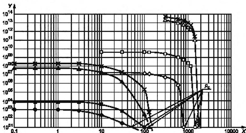
$X$  — форвакуумное давление, Па;  $Y$  — степень сжатия;  $p_c$  — наибольшее выпускное давление, Па
