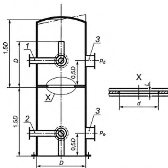
1 — патрубок напуска газа, 2 — патрубок напуска газа и точка измерения температуры  $T_D$ ; 3 — патрубок для подсоединения вакуумметра и масс-спектрометра,  $D$  — внутренний диаметр измерительной камеры,  $m$ ,  $L$  — толщина стенки в диаметре отверстия,  $m$ ,  $p_d$ ,  $p_e$  — давления в измерительной камере, Па (или мбар)
