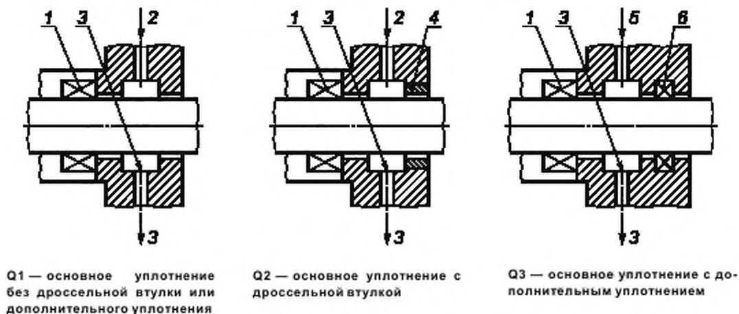
Рисунок E.4 — Примеры компоновок уплотнений с охлаждением
