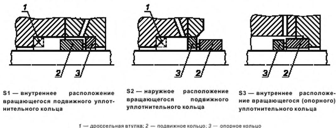
Рисунок Е.2 — Примеры компоновок одинарного торцевого уплотнения
