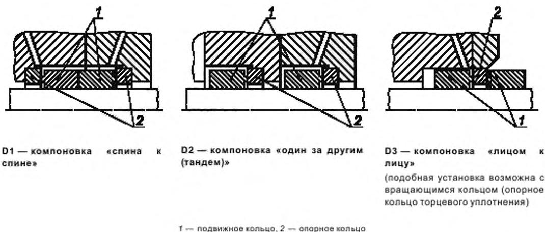
Рисунок E.3 — Примеры компоновок составного торцевого уплотнения
