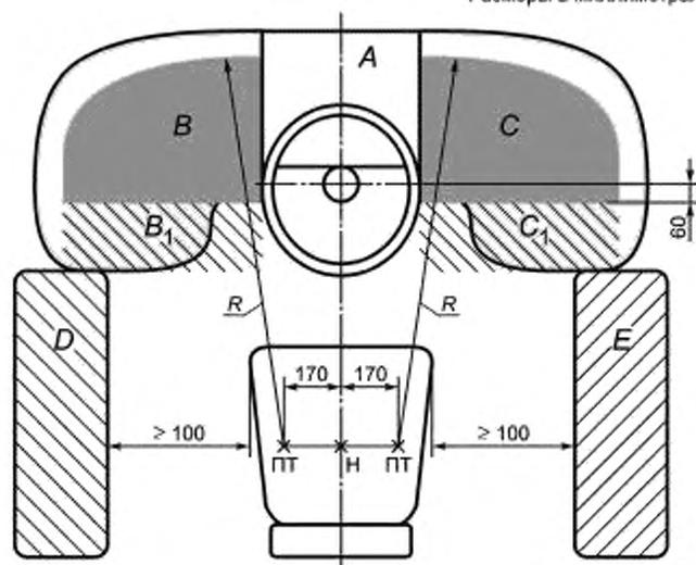
A — зона A (3.1.4); B — зона B (3.1.5); B<sub>1</sub> — зона B<sub>1</sub> (3.1.7); C — зона C (3.1.6); C<sub>1</sub> — зона C<sub>1</sub> (3.1.8); D — зона D (3.1.9); E — зона E (3.1.10); точка H — соответствует водителю невысокого роста; R — диапазон досягаемости руки = 750 мм.
