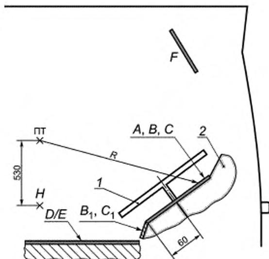
1 — рулевое колесо; 2 — приборная панель; A — зона A (3.1.4); B — зона B (3.1.5); B<sub>1</sub> — зона B<sub>1</sub> (3.1.7); C — зона C (3.1.6); C<sub>1</sub> — зона C<sub>1</sub> (3.1.8); D — зона D (3.1.9); E — зона E (3.1.10); F — зона F (3.1.11); точка H — соответствует водителю невысокого роста; R — диапазон досягаемости руки = 750 мм
