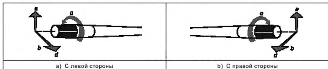
Примечание — Стрелки показывают направление движения для включения/увеличения (кроме сигнала поворота).
