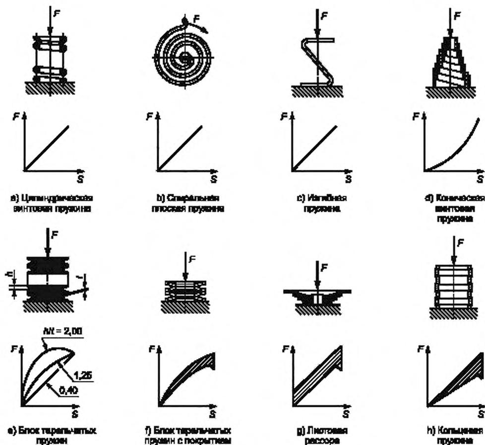
$F$  — нагрузка;  $s$  — деформация в направлении действия нагрузки;  $h, t$  — характерные размеры блока пружин
