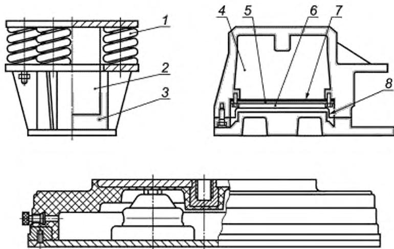
1 — пружина; 2 — поршень; 3 — демпфирующая жидкость; 4 — камера демпфирования; 5 — воздушный канал;
