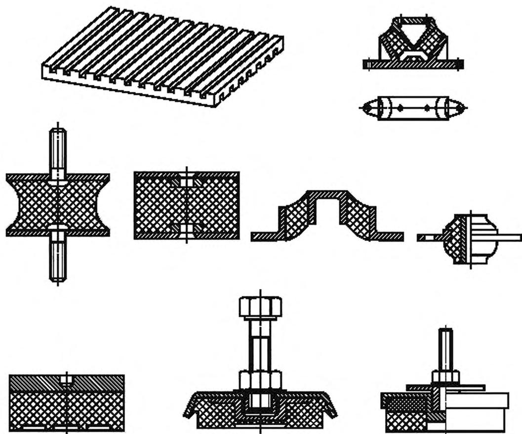
Рисунок А.1 — Примеры пружин из эластомерных материалов
