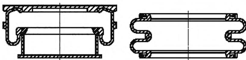
Рисунок А.4 — Примеры пневматических пружин
