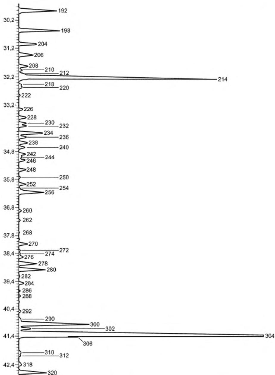
Рисунок X2.8 — Детальная хроматограмма стандартного образца бензина CGSB0496 (30,5 — 42,5 мин)
