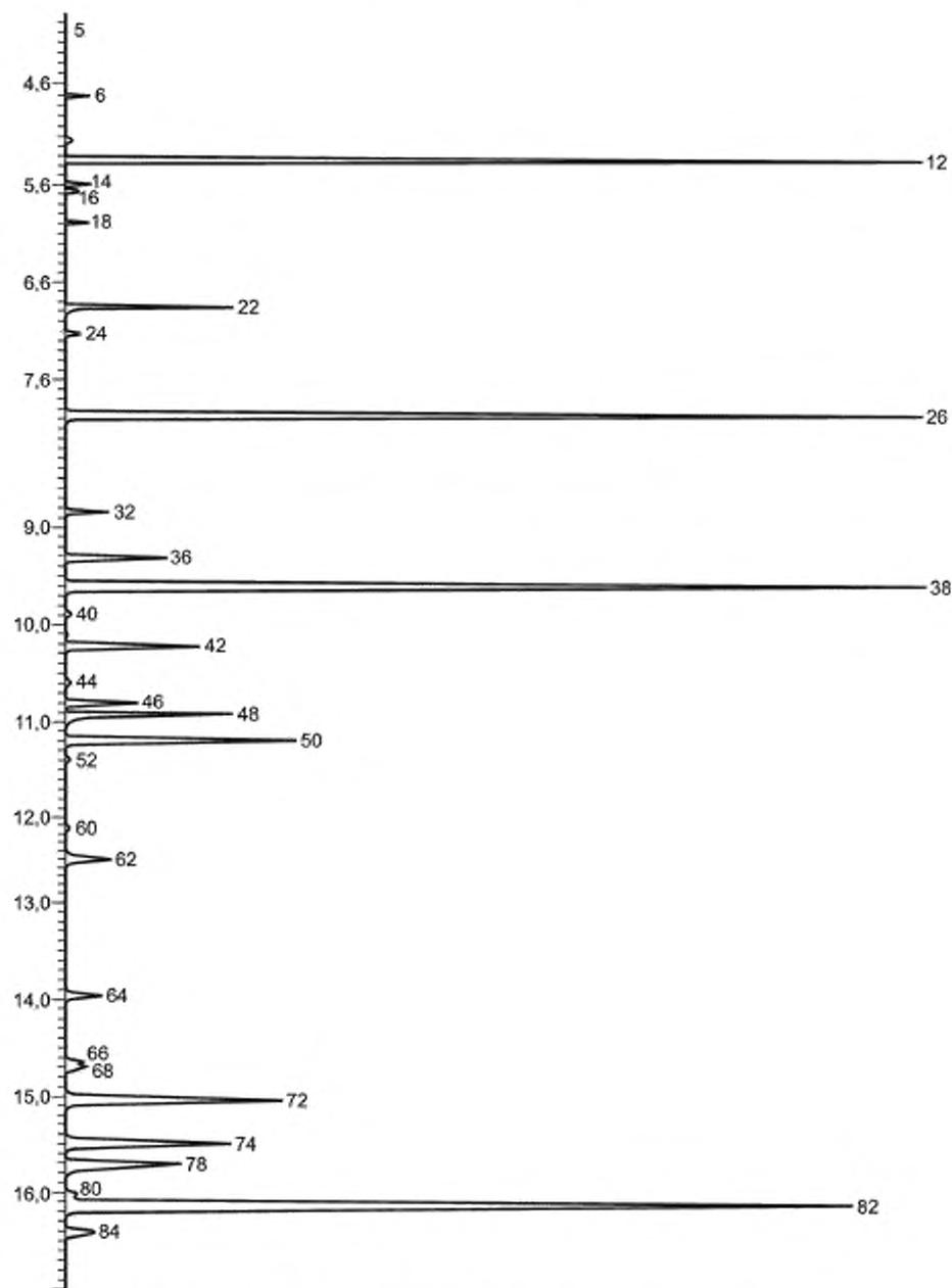
Рисунок X2.6 — Детальная хроматограмма стандартного образца бензина CGSB0496 (0 — 17 мин)
