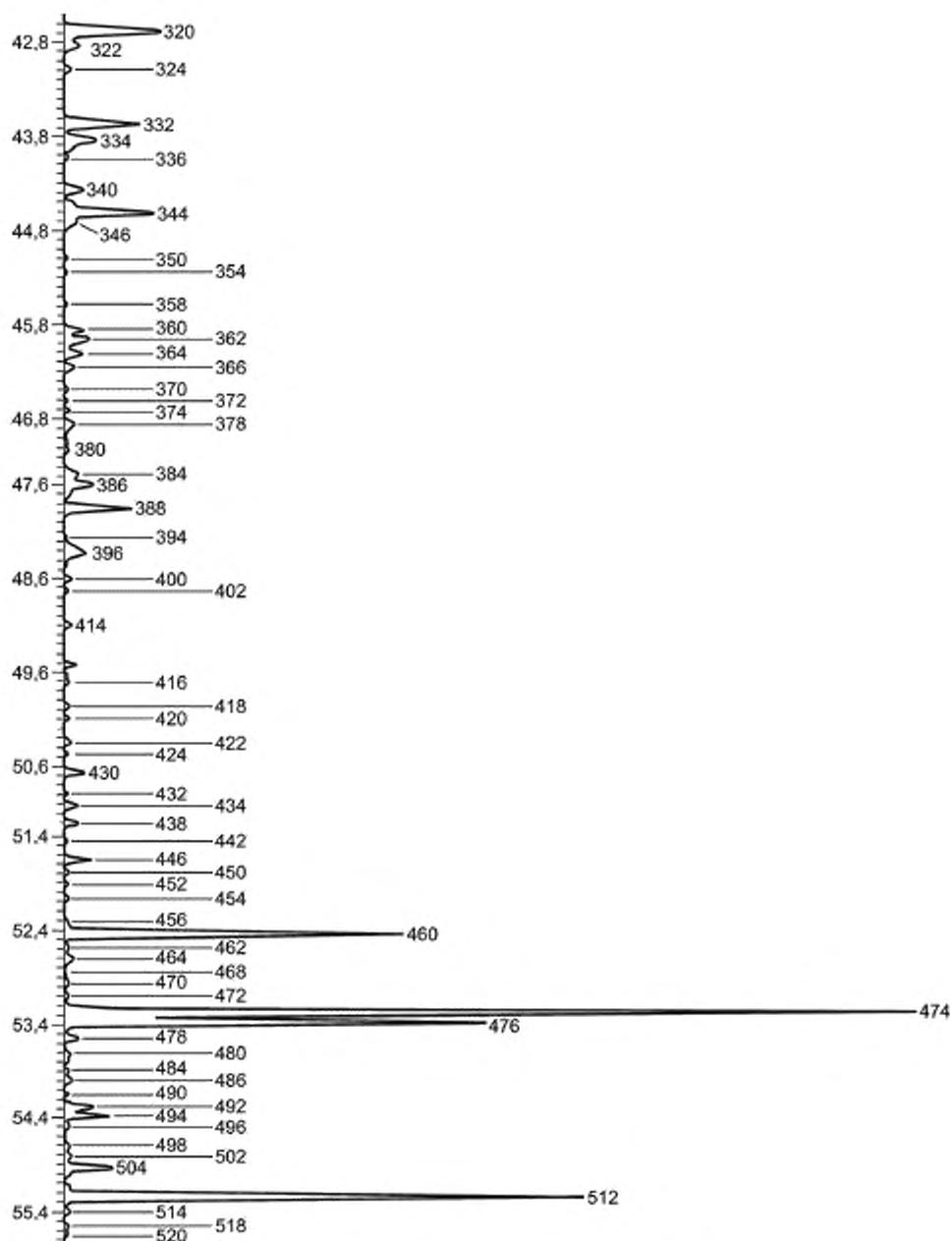
Рисунок X2.9 — Детальная хроматограмма стандартного образца бензина CGSB0496 (42,5 — 55,5 мин)
