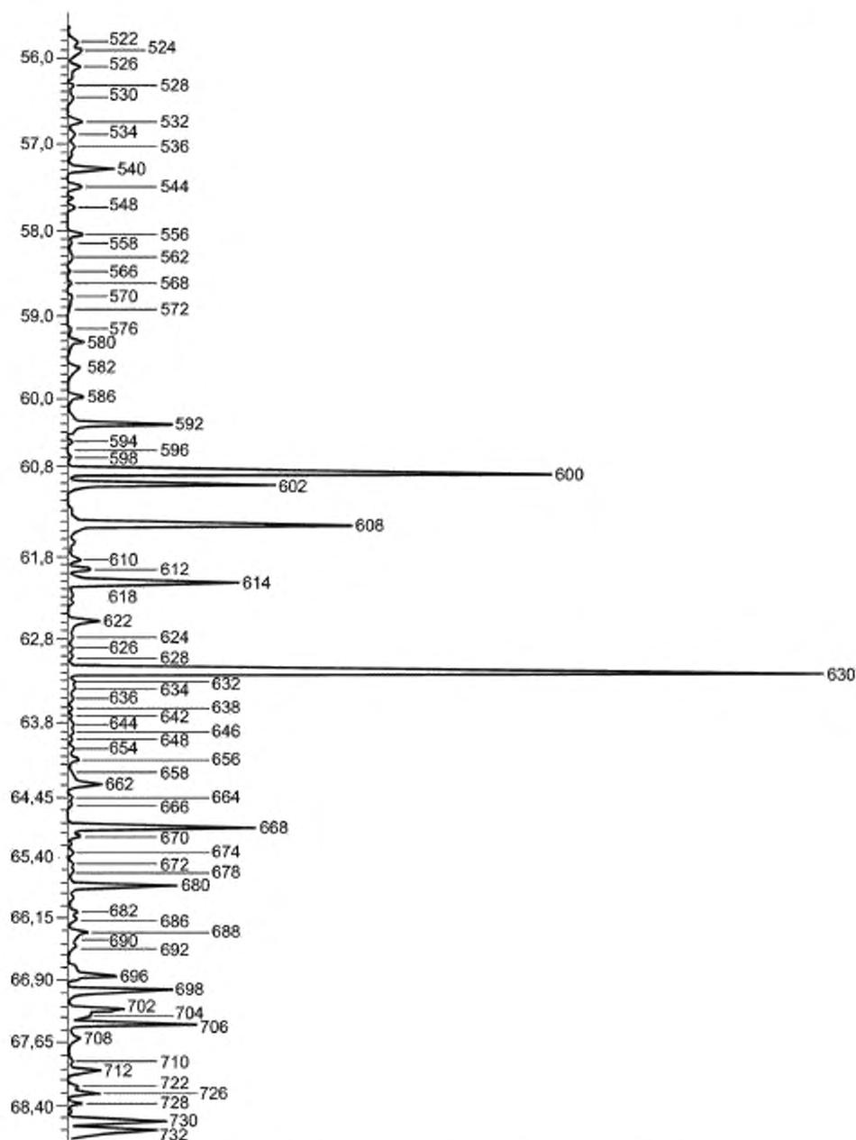
Рисунок X2.10 — Детальная хроматограмма стандартного образца бензина CGSB0496 (55.5 — 68.5 мин)
