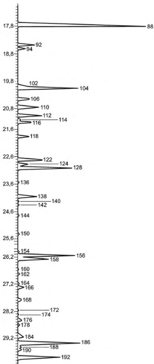
Рисунок X2.7 — Детальная хроматограмма стандартного образца бензина CGSB0496 (17 — 30,5 мин)
