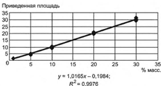
Рисунок A2.3 — Определение расчетного отклика при анализе трет-бутанола методом ИНА
