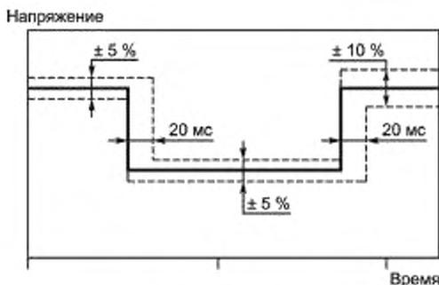
Рисунок 6 — Допустимые отклонения формы провала напряжения
