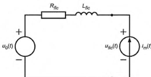
Рисунок 4 — Расчетная электрическая сеть для моделирования
