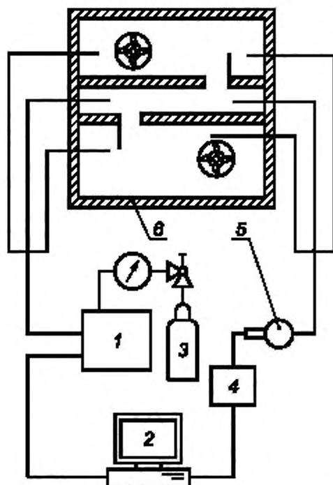
1 — газ; 2 — обработка данных; 3 — индикаторный газ; 4 — газоанализатор; 5 — насос; 6 — исследуемый участок
