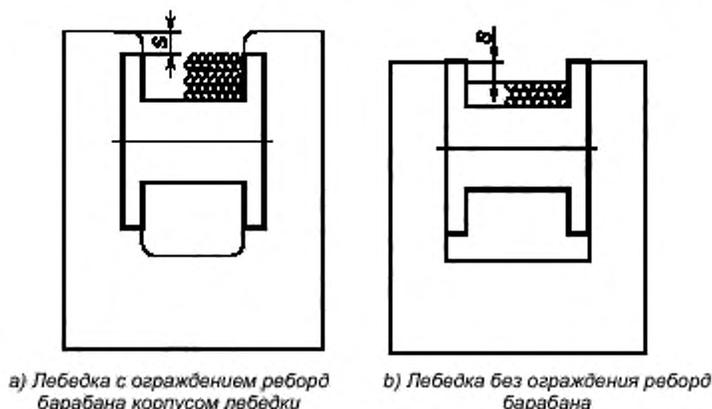
Примечание — Материал корпуса может охватывать барабан полностью (360°) или частично при наличии дополнительных элементов, гарантирующих, что канат останется на барабане.
