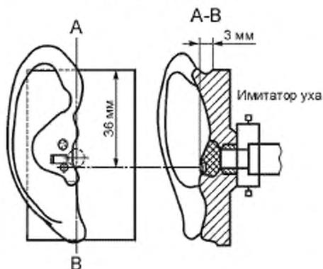
Переходная характеристика микрофона внутриканального слухового аппарата в свободном поле
