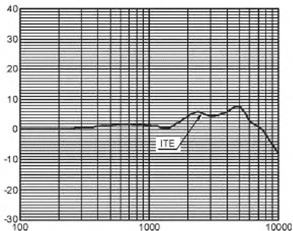
Рисунок А.2 — Положение микрофона и соответствующая переходная характеристика микрофона внутришного слухового аппарата в свободном поле
