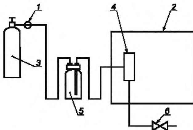
1 — редуктор; 2 — хроматограф; 3 — баллон с рабочим газом; 4 — встроенное устройство дозирования СУГ;
