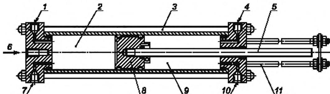
1 — отверстие для подсоединения манометра; 2 — камера с образцом СУГ (отобранная проба или ГСО-СУГ); 3 — стяжные болты; 4 — отверстие для подсоединения манометра; 5 — штатив поршня; 6 — отверстие для подачи СУГ (при отборе пробы или при подаче на анализ); 7 — отверстие для клапана; 8 — поршень; 9 — камера рабочего газа; 10 — отверстие для подсоединения линии подачи рабочего газа; 11 — штатив-ограничитель
