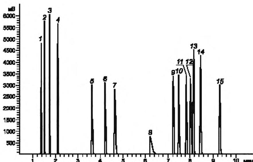
1 — метан; 2 — этан; 3 — этилен; 4 — пропан; 5 — пропен; 6 — изобутан; 7 — *n*-бутан; 8 — ацетилен; 9 — *транс*-бутен-2, 10 — бутен-1; 11 — изобутен; 12 — *цис*-бутен-2; 13 — изопентан; 14 — *n*-пентан; 15 — бутадиев-1,3
