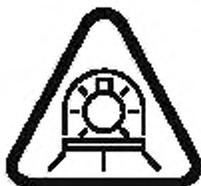
**А.2** Символ лампы с экранированием, указывающим, что лампа может работать в светильнике без защитного экрана
