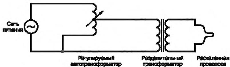
Рисунок 2 — Испытательная цепь
