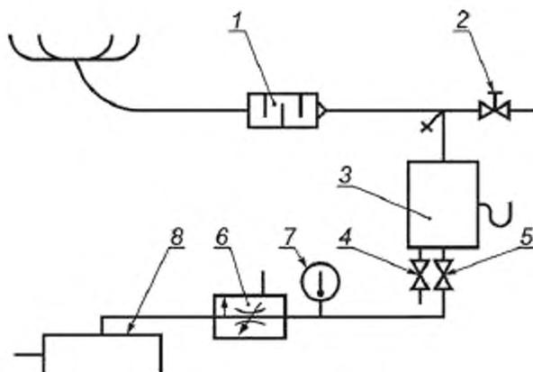
1 — глушитель; 2 — дроссельный клапан; 3 — демпфирующая камера с подогревателем; 4 — клапан А, 5 — клапан В; 6 — перепускное устройство; 7 — датчик температуры; 8 — дымомер
