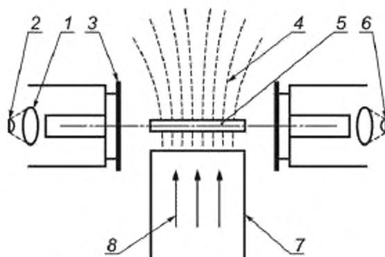
1 — коллимирующая линза; 2 — источник света; 3 — экран; 4 — поток отработавших газов;
