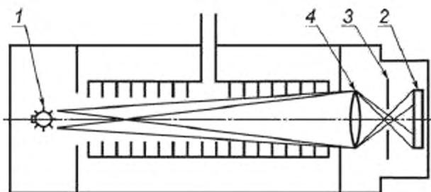
1 — источник света, 2 — приемник света; 3 — экран; 4 — линза
