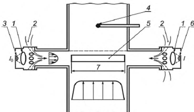
1 — коллимирующая линза; 2 — воздух; 3 — источник света; 4 — измерительное устройство;
