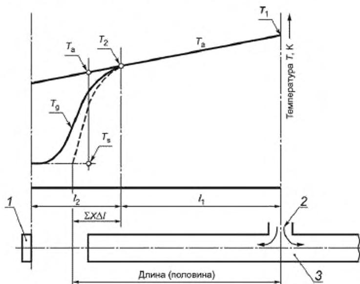
1 — приемник света; 2 — подвод пробы газа; 3 — измерительная камера
