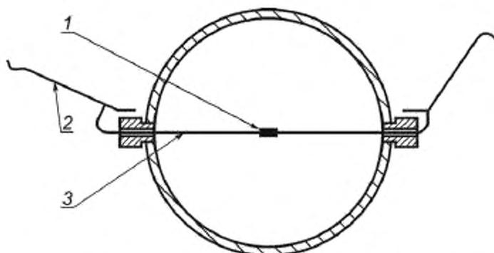
1 — соединение термопар; 2 — провод диаметром около 0,7 мм, 3 — провод диаметром около 0,12 мм
