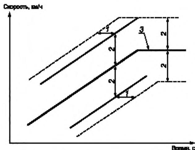
1 — испытательный цикл № 1; 2 — испытательный цикл № 2; 3 — заданная кривая
