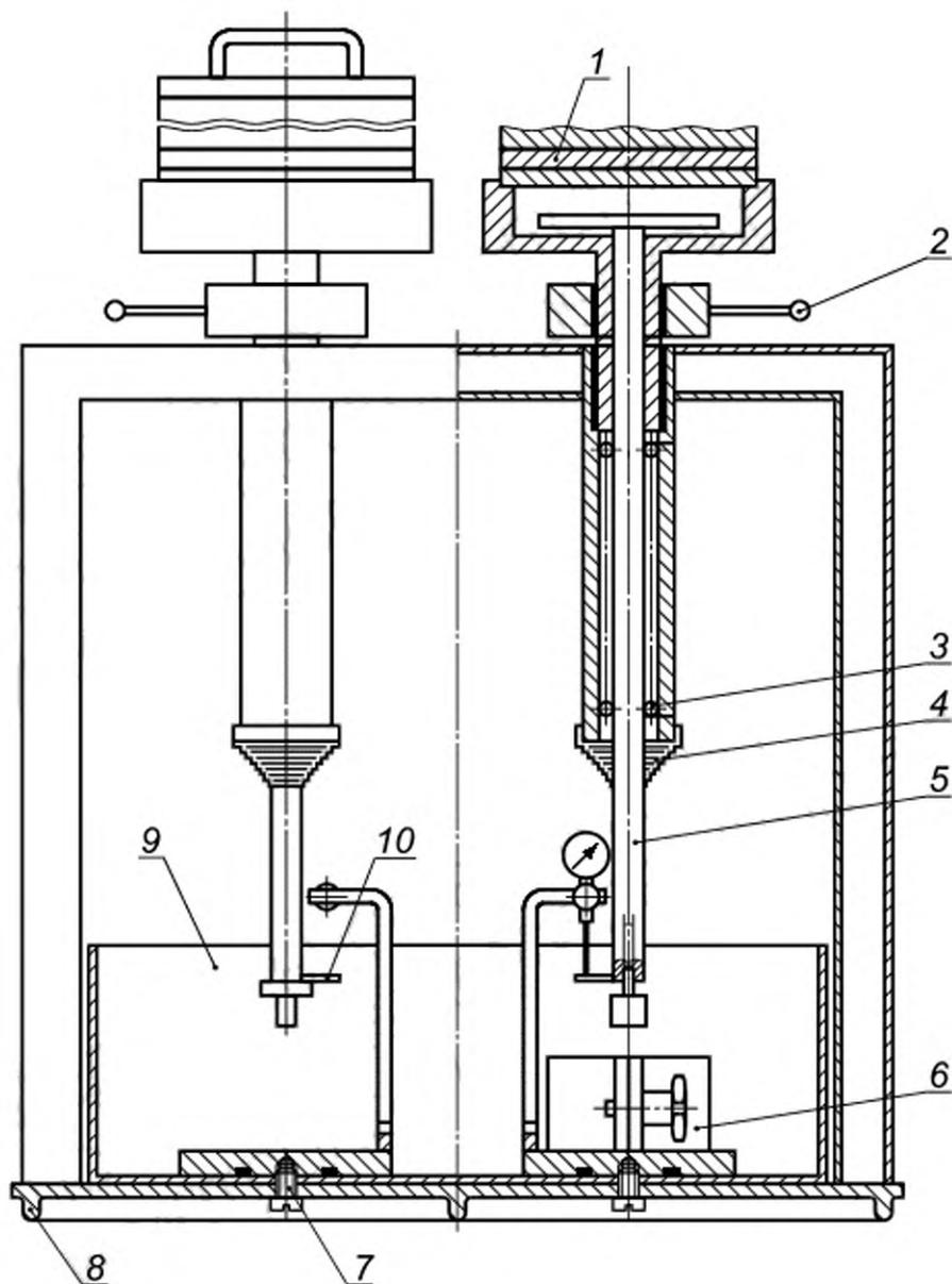
1 — гиря-разновеска; 2 — подъемный механизм; 3 — шариковые втулки; 4 — защитный кожух; 5 — шток; 6 — зажимная форма;
