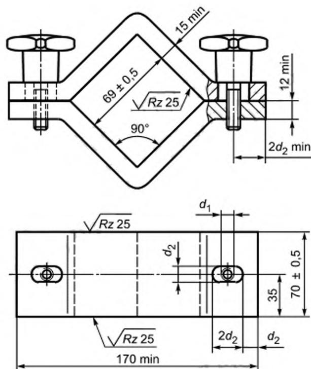
$d_1$  — диаметр резьбы;  $d_2$  — диаметр направляющей прорези
