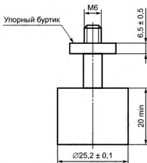
Рисунок 3 — Испытательный штамп площадью основания 500 мм<sup>2</sup>
