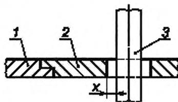
1 — стол; 2 — вставка стола; 3 — шпindel режущего инструмента;
