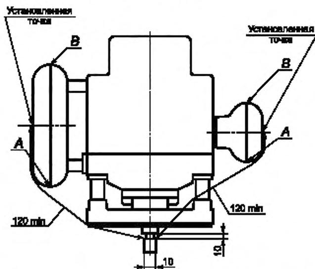
Рисунок 101 — Измерение расстояния между рукояткой и фрезой
