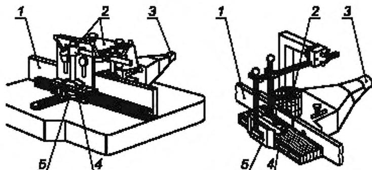
1 — направляющая; 2 — ограждение; 3 — патрубок выброса стружки; 4 — прижимное устройство стола;
