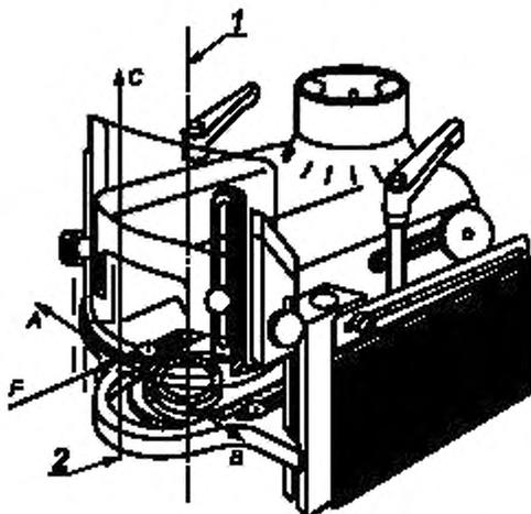
1 — ось шпинделя; 2 — точки приложения сил и измерения на направляющей опоре;
