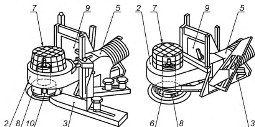
1 — режущий инструмент с подшипником; 2 — защита рук; 3 — заходное устройство; 4 — опора; 5 — патрубок выброса стружки;
