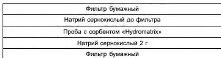
Рисунок 5.3 — Схема заполнения экстракционной ячейки для экстракции сырого жира
