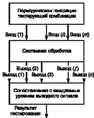
Рисунок А.8 — Применение тестирующей комбинации для обнаружения отказов
